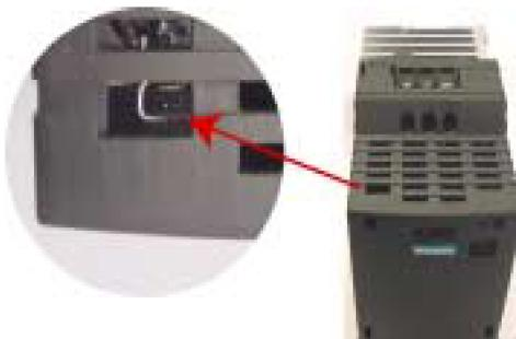
Obr. 20 Propojka volby provozu 50 Hz / 60 Hz
